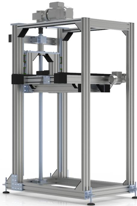
Der Spindelaufzug **17DV** ermöglicht sehr präzises Stoppen und mehrere Stopppositionen. Er ist mit einer Spindel, Elektromotor mit Bremse, schienenförmigen Linearführungen und Linearwagen ausgestattet.
